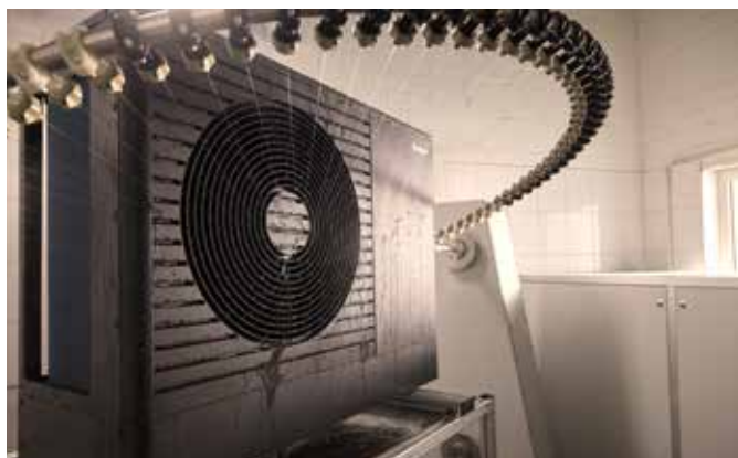
Preizkus odpornosti na vodo za zaščito tudi v ekstremnih padavinah
