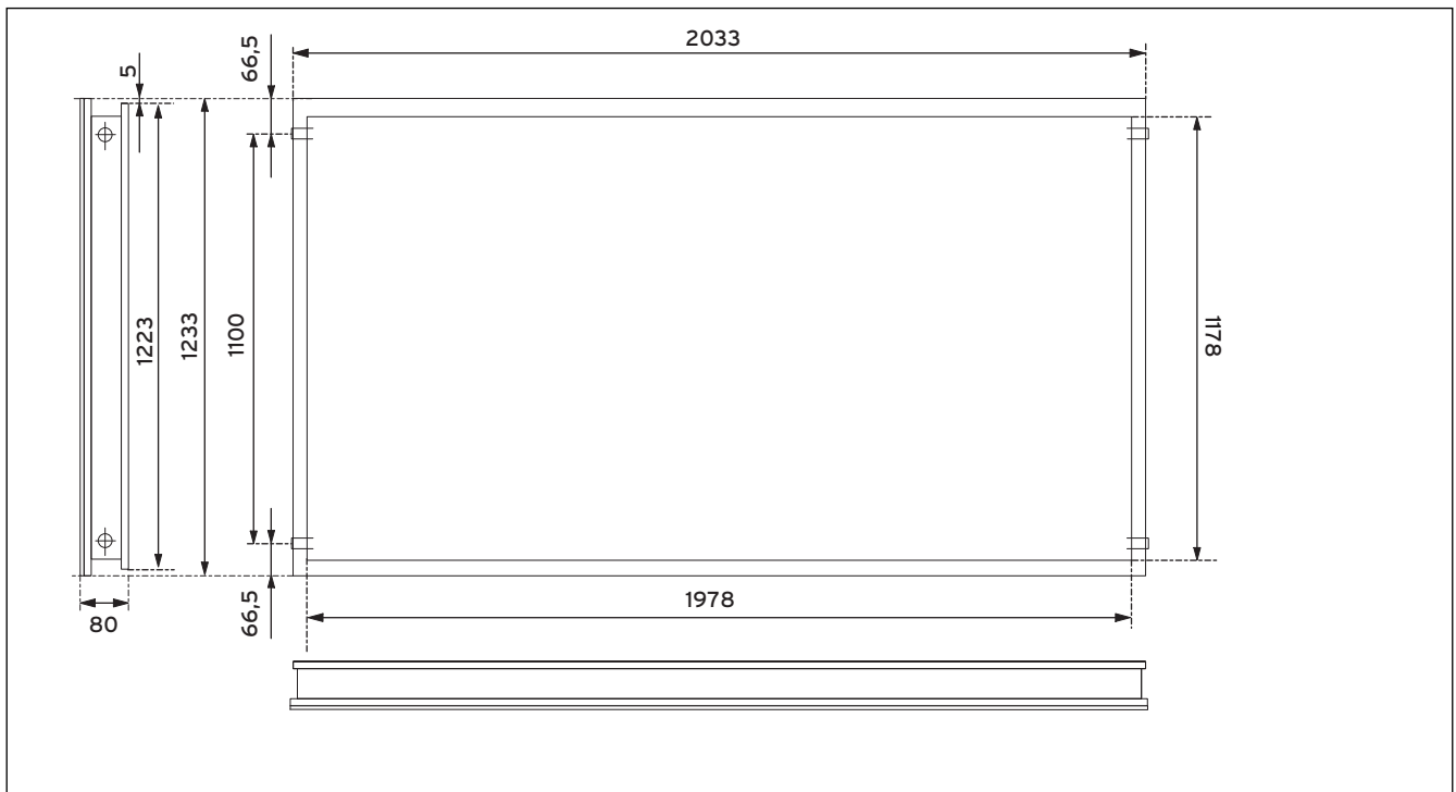
SI. 12.2 Dimenzijska risba za VFK 145/2 H
